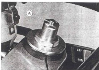
A. Einsteller für Ausfederungsdämpfung
