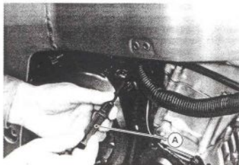
A. Einsteller „A“ für Leerlaufregulierschraube: 57001-1239
