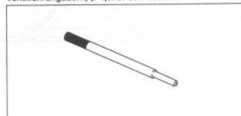
Ventilführungsstahle, \varnothing 4,5: 57001-1333
