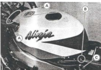
A. Schrauben für hintere Rohre B. Befestigungsschrauben
