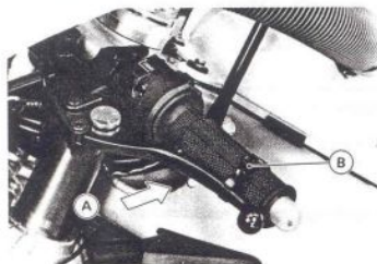
A. Den Kupplungshebel betätigen. B. Halteband
